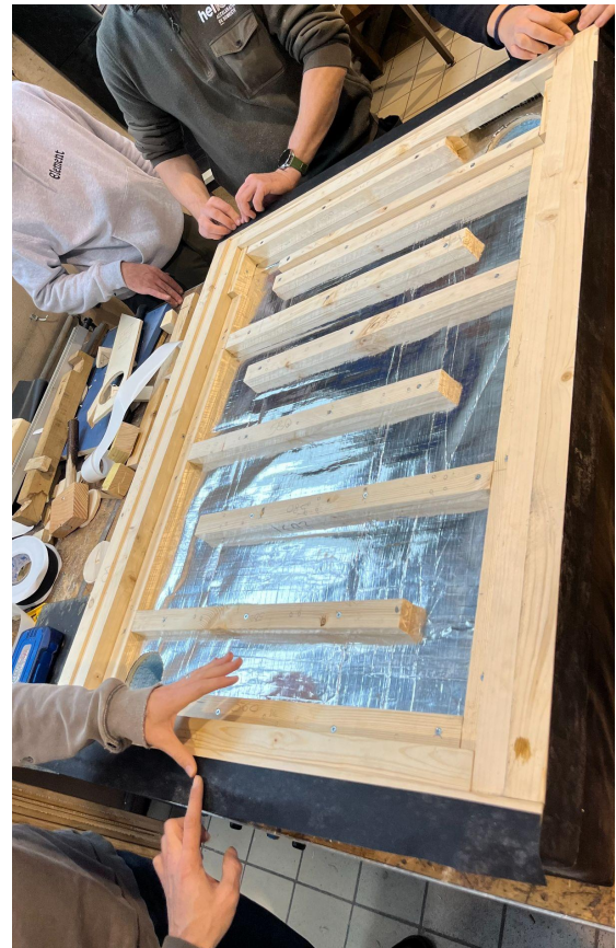
Figure 9: Chicanes découpées et fixées, vue de face
