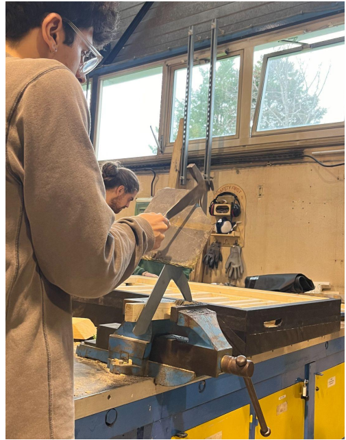
Figure 11: Découpe d'ardoise avec marteau d'ardoisier et enclume
