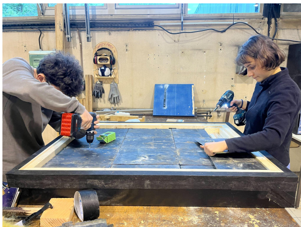
Figure 10: Fixation des ardoises sur les chicanes
