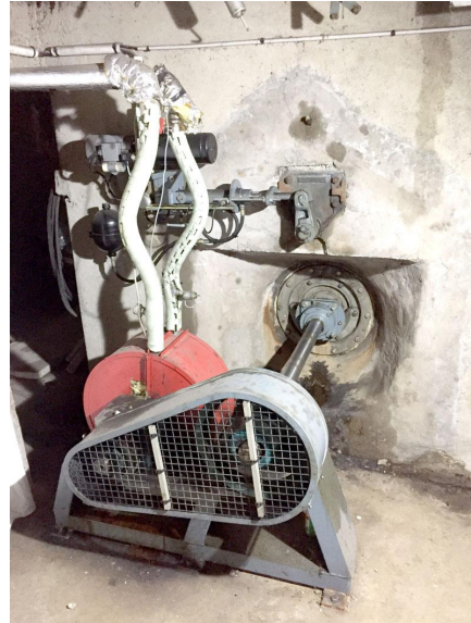
Figure 10 : Turbine et bouchotherme (en rouge) du Moulin d'Apach [11]
