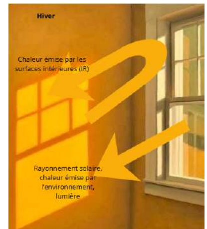
Figure 1: Fonctionnement des vitrage à revêtements en hiver et en été
